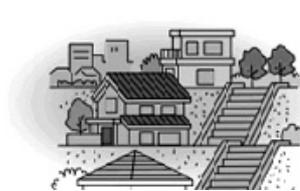
地盤がゆるみ、崩れる危険が。水抜き穴から濁り水が出始めたら要注意。
