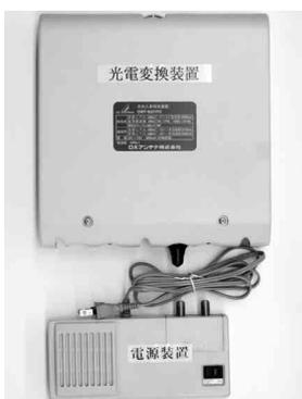
交換する光電変換装置と電源装置
