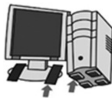
固定器具、耐震マット使用例
