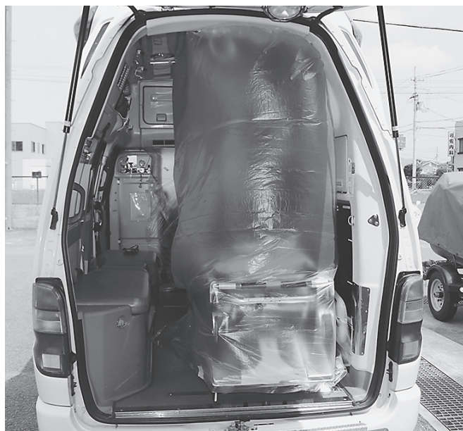
救急車内ビニール養生例
